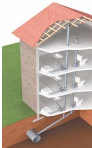
Esempio di posa su grossi diametri
