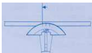
Fase 2 - Porre il tubo nella pinza curvatubi.
