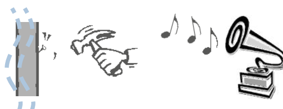
Trasmissione per via strutturale
