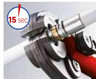
4) Pressatura del raccordo
